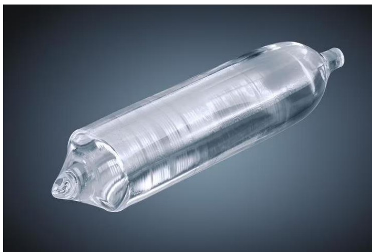
Figura 25. Barra de silicio formada a partir de un cristal de silicio (semilla) por el método de Czochralski. Las obleas se obtienen cortando con sierras especiales la barra en rodajas.
