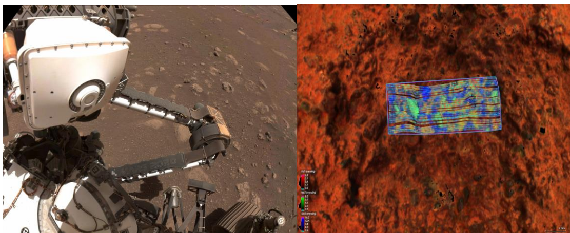
Figura 65. Izquierda: Instrumento PIXL del Mars Rover Perseverance y Derecha: Imagen de una roca de Marte creada usando PIXL, que determina su composición mineral con rayos X. Fuente: https://www.nasa.gov/missions/mars-2020-perseverance/perseverance-rover/heres-how-ai-is-changing-nasas-mars-rover-science/
