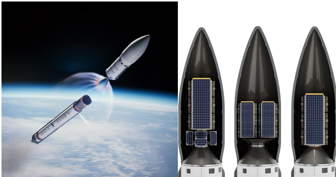
Figura A4.1. Imagen del lanzador MIURA 5 de dos etapas y configuraciones de carga útil. Fuente: https://www.pldspace.com/es/miura-5
