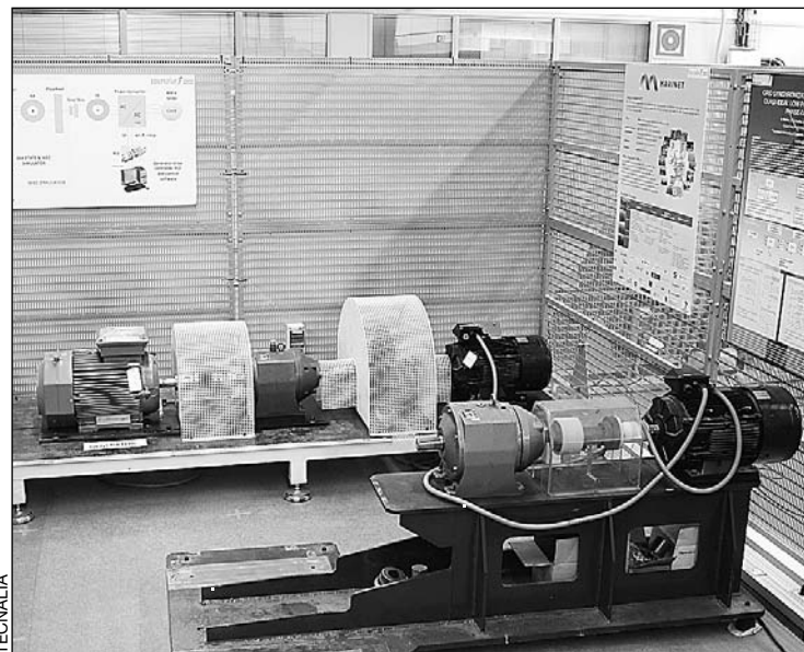
El Laboratorio Eléctrico de Tecnia permite simular el comportamiento de la turbina de cualquier convertidor de energía marina.
