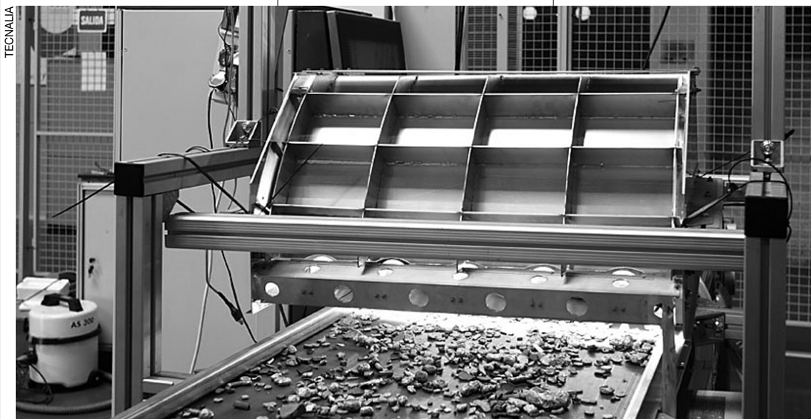
El porcentaje de eficacia de Hyperspectral Metal Recycler alcanza el 98% en mezclas de aluminio, acero inoxidable, cobre, latón y plomo.
